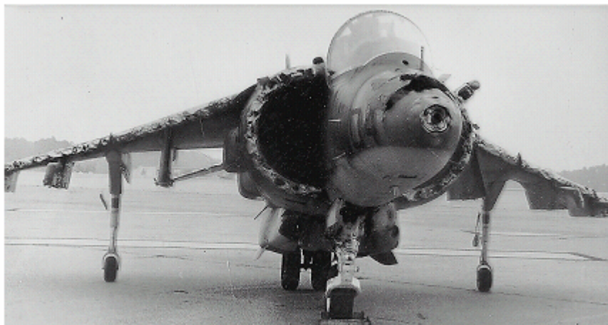
Рис. 33 Военный самолет после попадания в град
