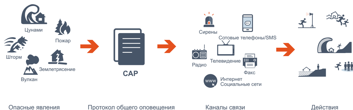
Рисунок 6. Оповещение CAP само по себе не содержит всего, что касается чрезвычайной ситуации, оно просто несет некоторые факты, которые необходимы каждому. (Источник: МСЭ)
