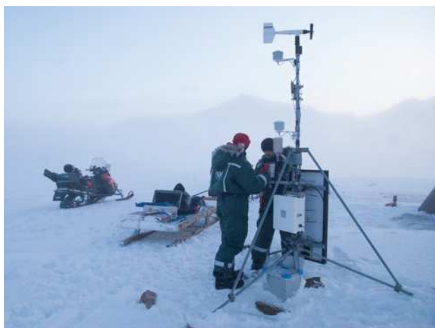
Рисунок 9. Полевые работы и установка в холодный день в середине февраля новых датчиков на станции мониторинга многолетней мерзлоты в Янссонхаугене (78° с.ш.) на Шпицбергене (фото: Кетиль Исаксен)
