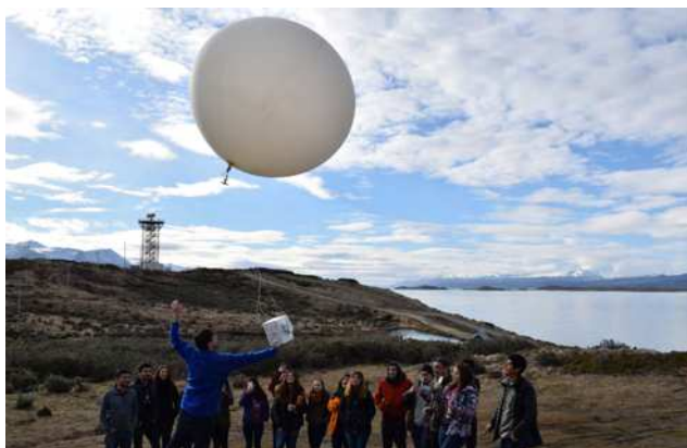
Рисунок 1. Наблюдение озона в Ушуае, Аргентина. Озонзонды измеряют озон и метеорологические переменные на разных высотах по мере подъёма зонда до тех пор, пока шар-пилот не лопнет (Источник: Лино Кондори).
