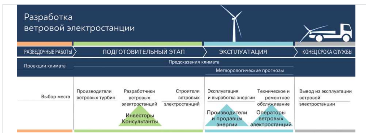
Рис. 1. Этапы разработки ветровой электростанции, на каждом этапе разработки участвуют заинтересованные стороны и используется климатическая информация разных временных масштабов. Заблаговременность метеорологических прогнозов ограничена двумя неделями, тогда как предсказания климата имеют большую заблаговременность — от нескольких сезонов до нескольких десятилетий, а проекции климата являются еще более долгосрочными — от нескольких десятилетий до нескольких столетий.
