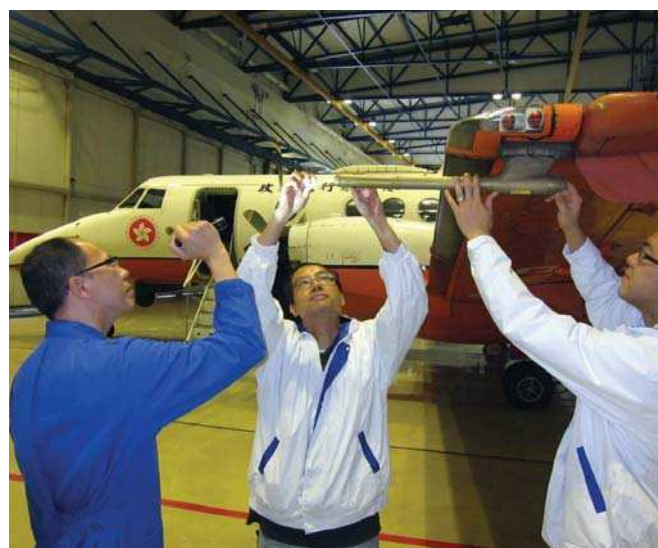
Коллеги из Обсерватории и Правительственной авиационной службы проверяют зонд для сбора метеорологических данных, установленный на самолете с неподвижным крылом Jetstream-41.
