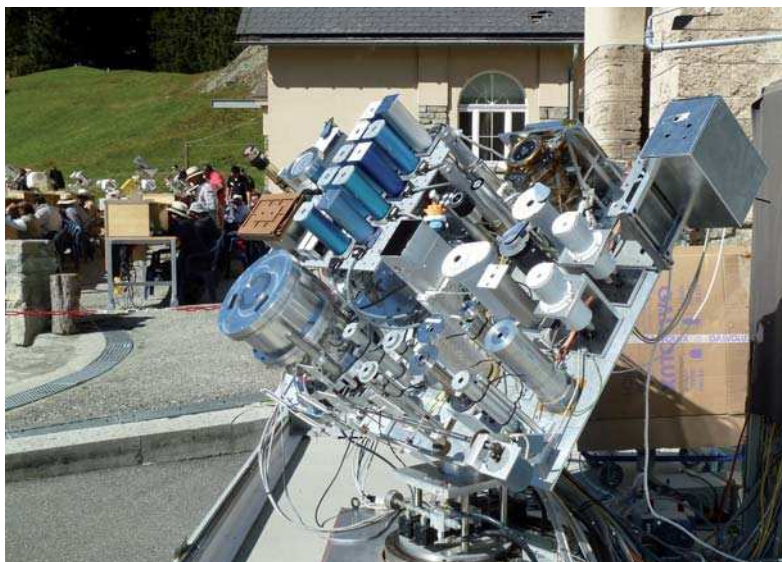
Устройство слежения за солнцем в ФМОД с радиометрами Группы международных эталонов (справа внизу) и криогенным радиометром (слева внизу)
