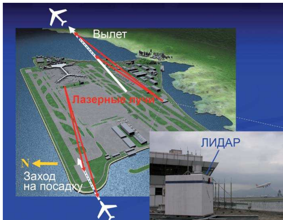
Схематическая диаграмма системы оповещения о сдвиге ветра с использованием лазерного локатора
