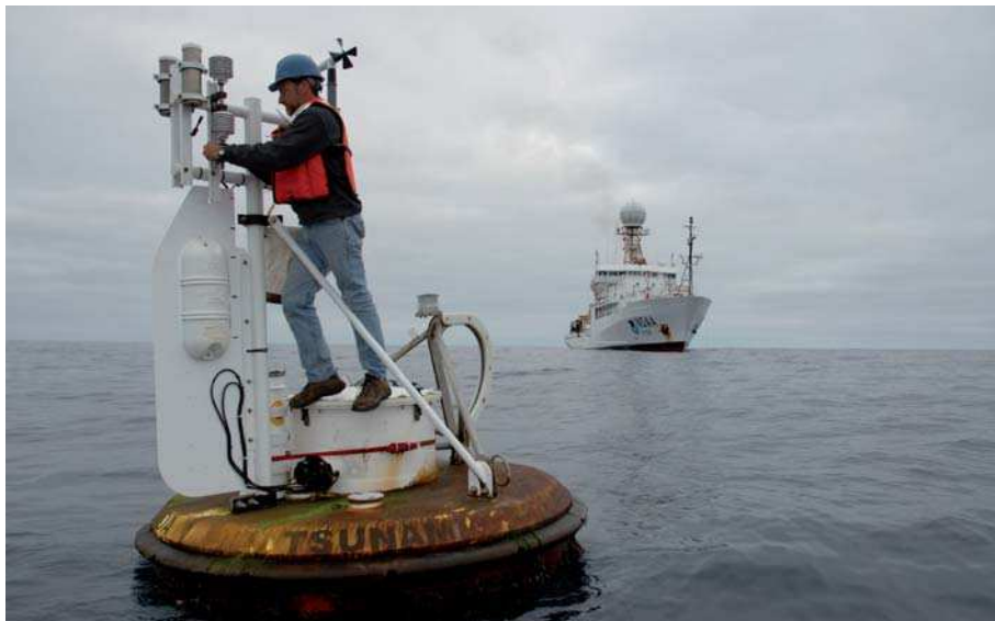
Рисунок 4 – Чилийский буй для предупреждения о цунами, обслуживание которого осуществлялось с борта американского научно-исследовательского судна «Рональд Г. Браун» объединенной Чилийско-Американской группой во время связанной с изучением климата миссии, проводившейся с целью ежегодного технического обслуживания станции «Стратус», которая входит в состав глобальной опорной сети заякоренных буйев. Буй для предупреждения о цунами был оснащен метеорологическими датчиками, чтобы его можно было использовать в качестве многофункциональной платформы. Во время этой миссии были введены в действие дрейфующие поверхностные буи ГСБД и ныряющие буи программы Арго.
