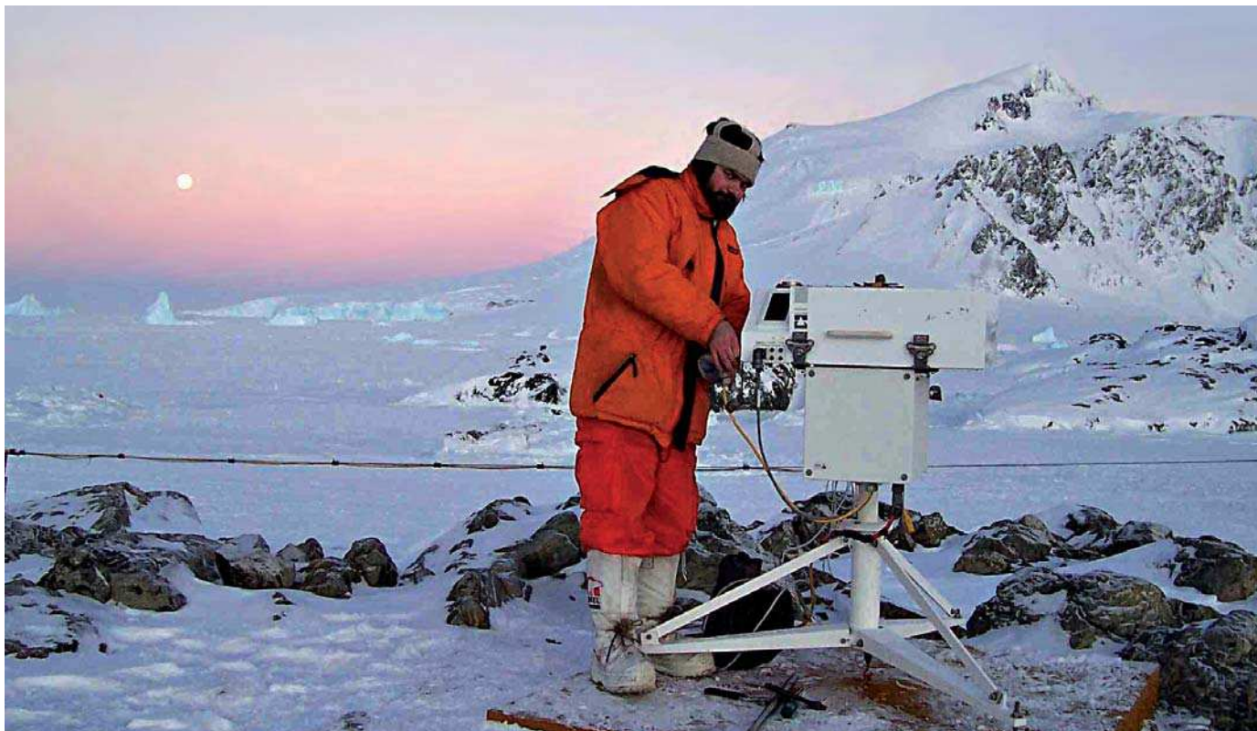
Измерения прибором Бруера на аргентинской станции Сан-Мартин на Антарктическом полуострове
