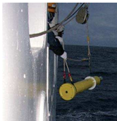
Рисунок 2 – Спуск на воду в Беринговом море 24 октября 2007 г. канадского ныряющего буя сети АРГО (Фото: Хироши Матцунага)
