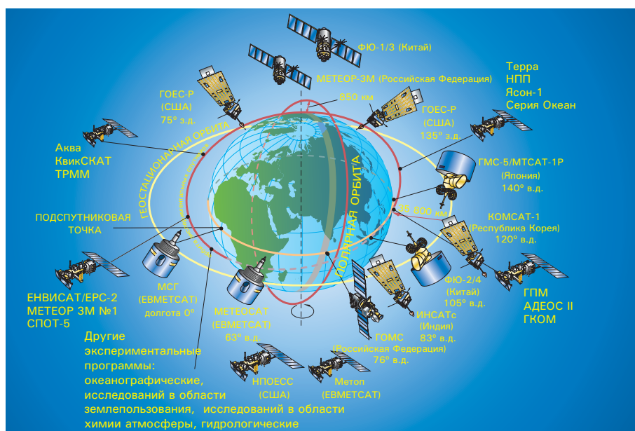
Рисунок 1 – Космический компонент Глобальной системы наблюдений, состоящий из трех групп спутников
