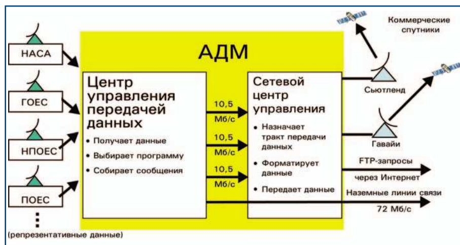
Рисунок 2 – Представление всей системы Systems View-2 (SV-2) функциональной и интерфейсной диаграммы АДМ
