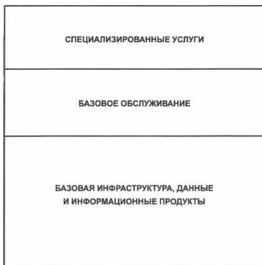
Рисунок 1 – Схематическое представление важнейших компонентов национальной системы обеспечения метеорологическими услугами. Базовая инфраструктура, данные и информационные продукты (иногда называемые „основные системы“) поддерживают обеспечение как базовых услуг для общества в целом, так и специализированных дополнительных услуг для индивидуальных потребителей.
