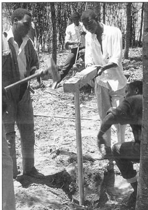
Монтаж труб доступа для детектора нейтронов на ферме в Центральной Кении для изучения взаимоотношений растений с деревьями в конкуренции за воду. Более глубокое понимание традиционных и новых систем совместного выращивания сельскохозяйственных и лесных культур требует количественного описания
