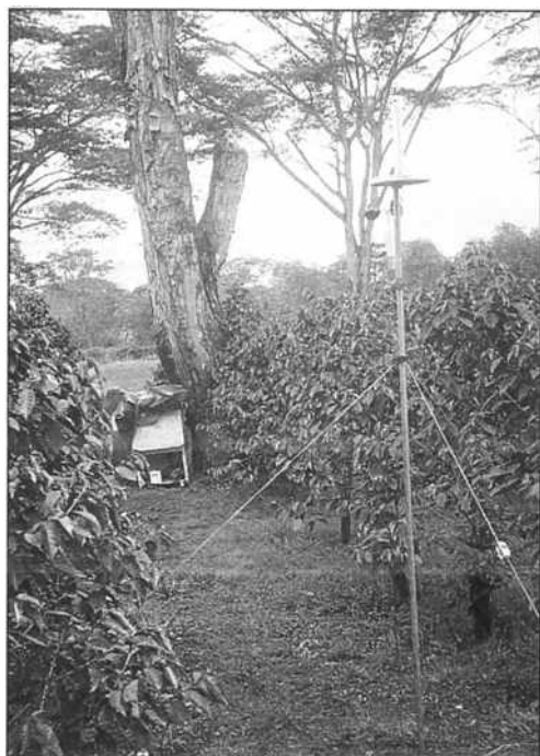
Измерения ветра, сравнения данных электрического чашечного анемометра со значительно более дешевым затененным измерителем скорости испарения Пизе, который использовался в качестве дополнительного анемометра, на исследовательской кофейной станции Лямунгу, на севере Объединенной Республики Танзания
