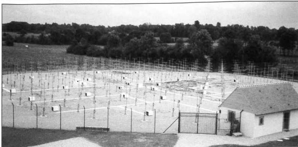
Рисунок 2 — Внешний вид ИПВ с частотой 52 МГц Метео-Франс, Ла-Ферте-Видам, Франция
