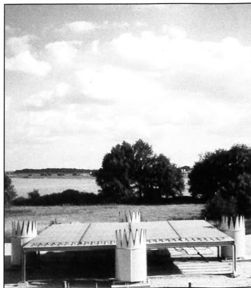
Рисунок 1 — Внешний вид антенны ИПВ с частотой 482 МГц и четырех акустических источников для дополнительной системы радиоакустического зондирования, которая измеряет виртуальную температуру. Метеорологическая обсерватория им. Линденберга, Служба погоды Германии
