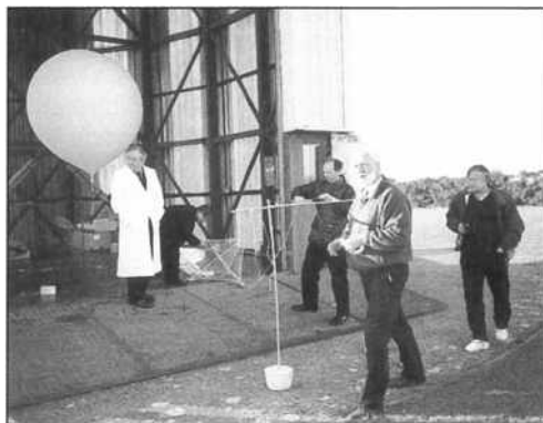
Подготовка „полета двойников“ для изучения характеристик радиозондов, показанных членам рабочей группы по аэрологическим измерениям на станции радиозондирования Кемборн (Соединенное Королевство)
