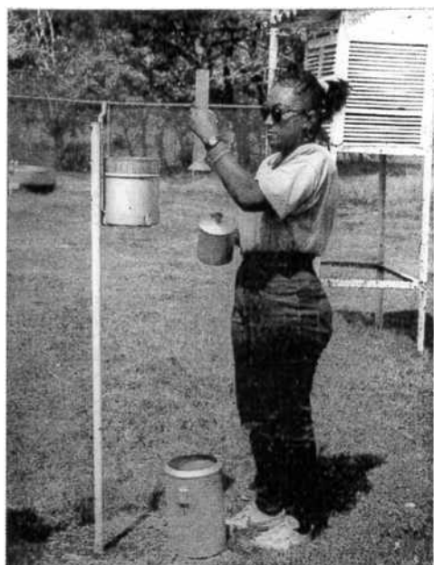
Совместный проект ИНДРГИ-ГТЦ в Доминиканской Республике. Мирабель Флорес снимает показания дождемера
