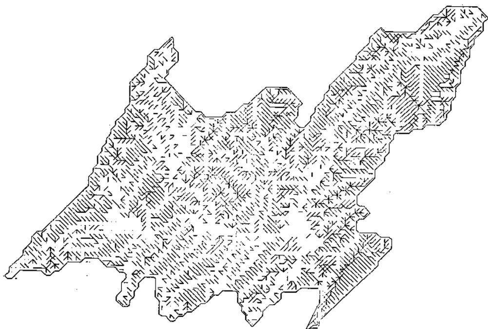
Рис. 2. Сеть стока в бассейне, определенная с помощью ЭВМ (см. в тексте)
