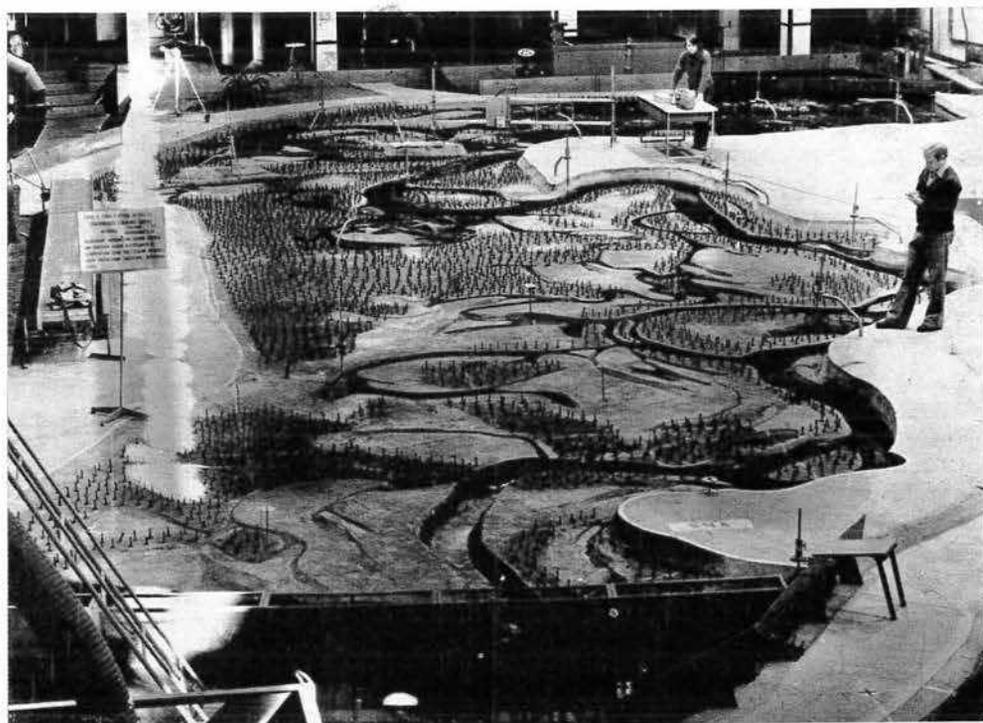
Рис. 1 — Гидравлическая модель извилистого речного русла на Главной экспериментальной базе ГГИ
