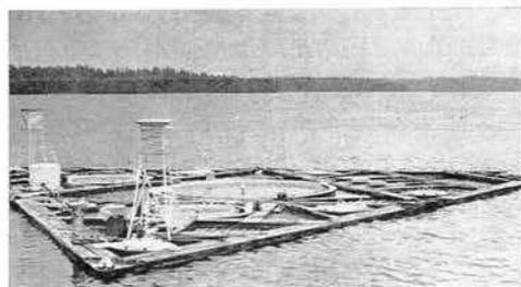
Рис. 2 — Плавающая платформа для измерений испарения на оз. Валдай
