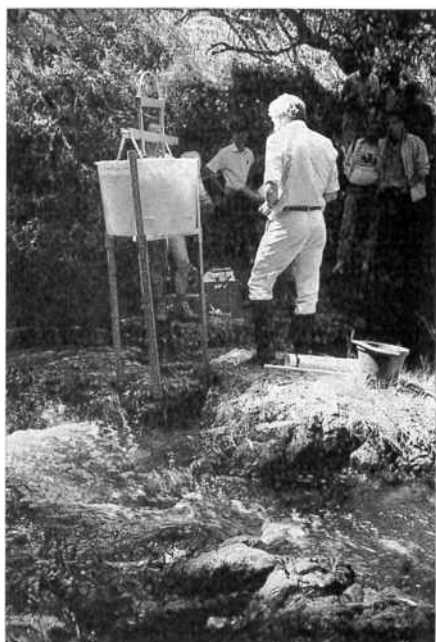
Измерение расхода воды методом разбавления соли в Новой Зеландии Фото: Н. С. Сехми
