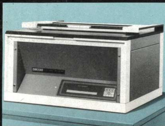
Факсимильный передатчик Алден 9650 GIII, считывающий плоские оригиналы
