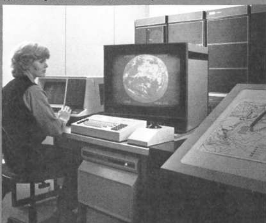
Контролируемое ЭВМ оборудование НРРТ-станций по приему и обработке данных.
