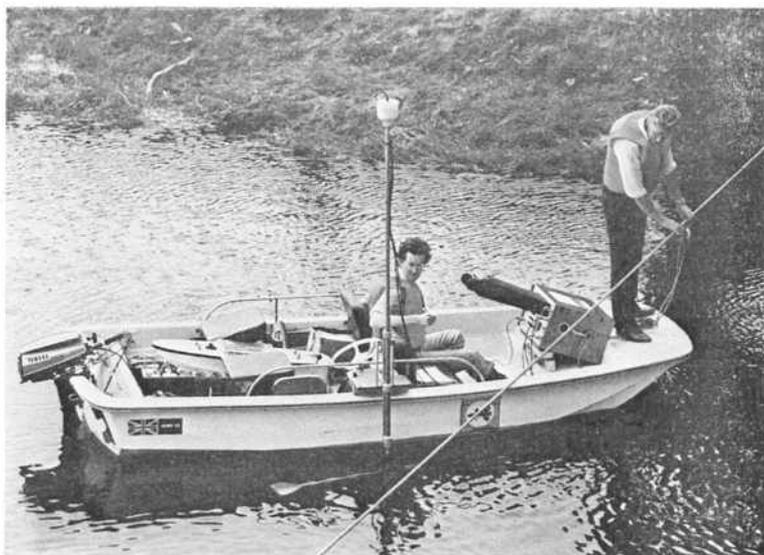
Демонстрация метода измерения скорости течения с помощью движущейся лодки на р. Экс
