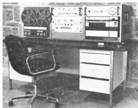
АВТОМАТИЧЕСКАЯ СТАНЦИЯ ПРИЕМА АРТ/WEFAX TIROS N С ЛАЗЕРНЫМ ДИКОДИРУЮЩИМ УСТРОЙСТВОМ
