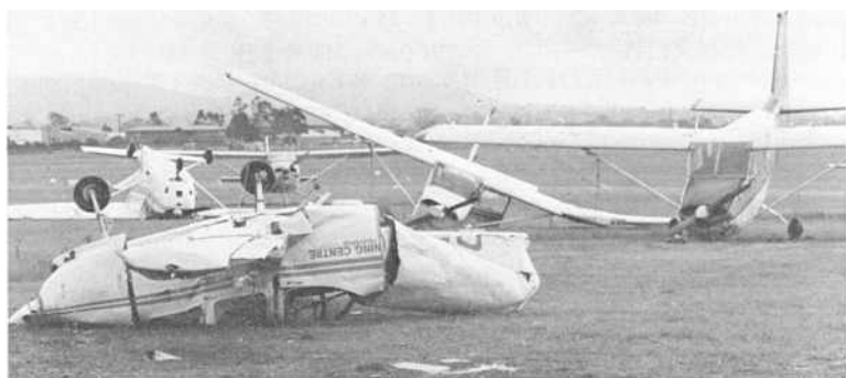
Самолет, поврежденный в аэропорту Арчерфилд (Брисбен) в результате сильного шквала 16 декабря 1980 г.
