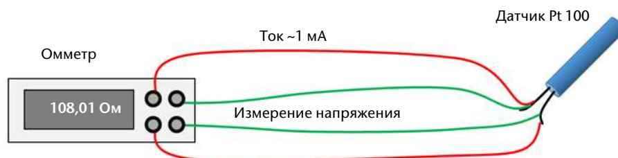
Рисунок 2.6. Четырехпроводная схема для считывания показаний датчика Pt100
