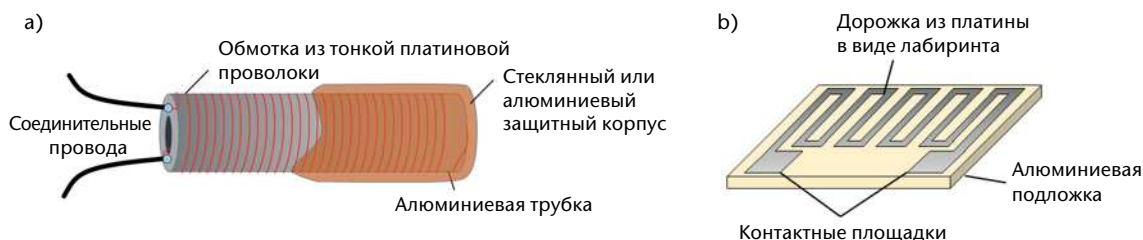
Рисунок 2.1. а) ПТС с проволоочной намоткой; б) тонкопленочный ПТС
