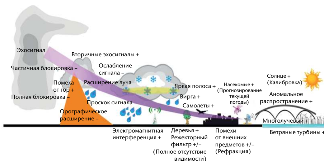
Рисунок 7.2. Метеорологический радиолокатор может обнаруживать многие объекты помимо метеорологических целей. На этой схеме показаны многие из этих характеристик. Знаки + или - показывают увеличение или уменьшение отражательной способности цели в результате этой характеристики. Эти артефакты необходимо удалять в случае количественных применений.
