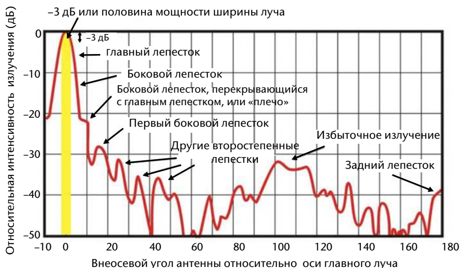
Рисунок 7.8. Общая диаграмма направленности излучения антенны. Следует отметить, что ширина антенного луча обычно определяется в точках половинной мощности (50 % или -3 дБ). Если цель обладает высокой отражаемостью, то мощность излучается и принимается со стороны главного лепестка и других боковых лепестков.
