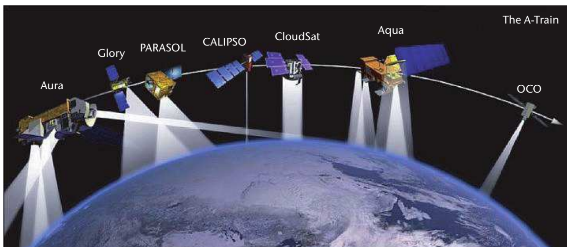
Рис. 4.4. А-Каскад. Интервал по времени пересечения экватора между спутниками, изучающими атмосферную радиацию (Glory, PARASOL, CALIPSO, CloudSat и EOS Aqua), составляет около 2 минут. Обратите внимание, что могут быть изменения в составе спутников, участвующих в А-Каскаде; к примеру, PARASOL был исключен после пяти лет работы на орбите; EOS Aura был добавлен; Glory не был выведен на орбиту при запуске; потерянный при запуске Orbiting Carbon Observatory орбитальная (обсерватория для наблюдений за углеродом (OCO)) будет заменен на OCO-2 и был добавлен спутник Программы по наблюдению глобального изменения (Global Change Observation Mission for Water - 1 (GCOM-W1)).
