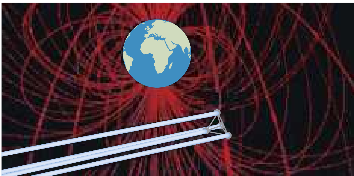
Рисунок 4.10. Четыре спутника MMS, входящих в группировку. Четырехгранная схема для захвата трехмерной (3-D) структуры встречающихся узлов перезамыкания.
