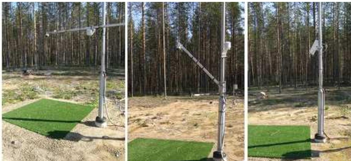
**Рисунок 2.8. Автоматический акустический прибор для измерения высоты снежного покрова со стальной монтажной балкой и столбом, закрепленным в бетонном основании (слева), наклонная монтажная балка для уменьшения накопления снега (посередине) и лазерный прибор, установленный под углом от вертикального монтажного столба (справа) (Соданкюля, Финляндия, фотографии предоставлены Финским метеорологическим институтом).**
