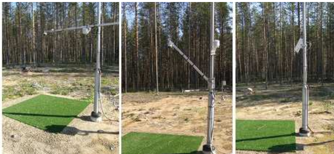
Рисунок 2.8. Автоматический акустический прибор для измерения высоты снежного покрова со стальной монтажной балкой и столбом, закрепленным в бетонном основании (слева), наклонная монтажная балка для уменьшения накопления снега (посередине) и лазерный прибор, установленный под углом от вертикального монтажного столба (справа) (Соданкюля, Финляндия, фотографии предоставлены Финским метеорологическим институтом).
