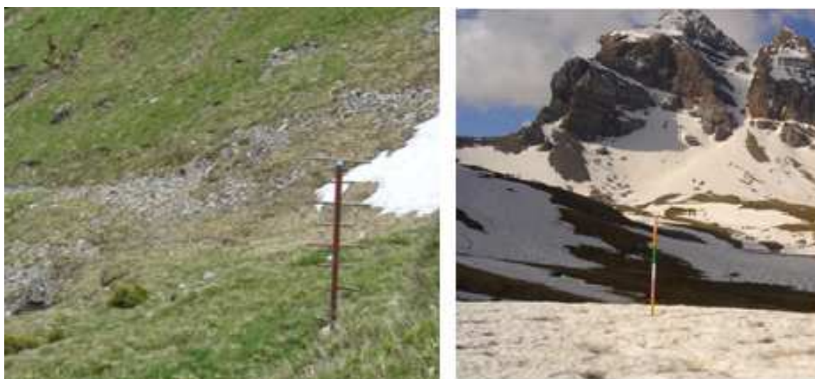
Рисунок 2.3. Вертикальная снегомерная рейка с горизонтальными поперечинами (слева, фото предоставлено Швейцарским институтом исследования снега и лавин, ВСЛ, Давос, Швейцария) и полосами с цветовой маркировкой (справа, фото предоставлено Государственным метеорологическим агентством Испании)
