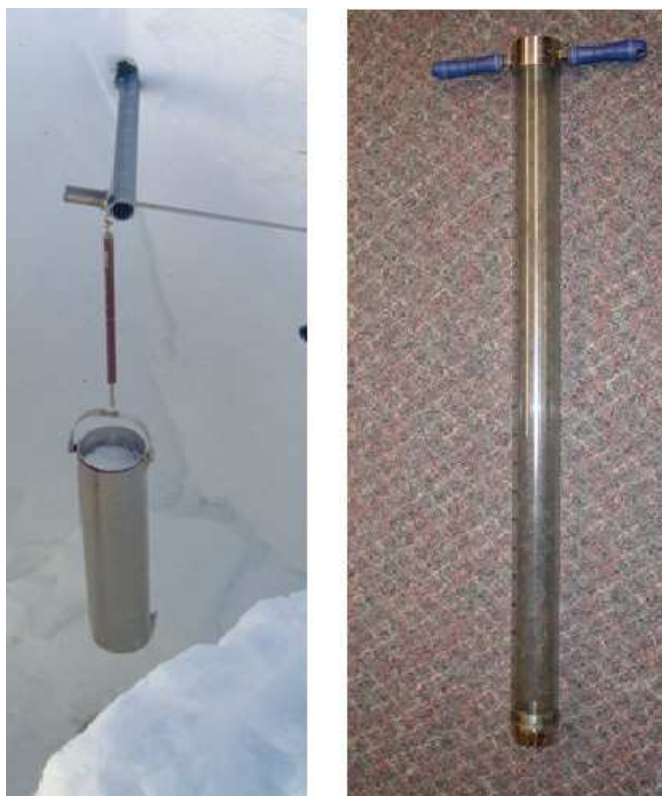
Рисунок 2.12. Объемный снегомер высотой 55 см во время взвешивания на пружинных весах (слева, фото предоставлено Швейцарским институтом исследования снега и лавин, ВСЛ, Давос, Швейцария) и цилиндрический снегоотборник (справа, фото предоставлено Министерством охраны окружающей среды Канады).
