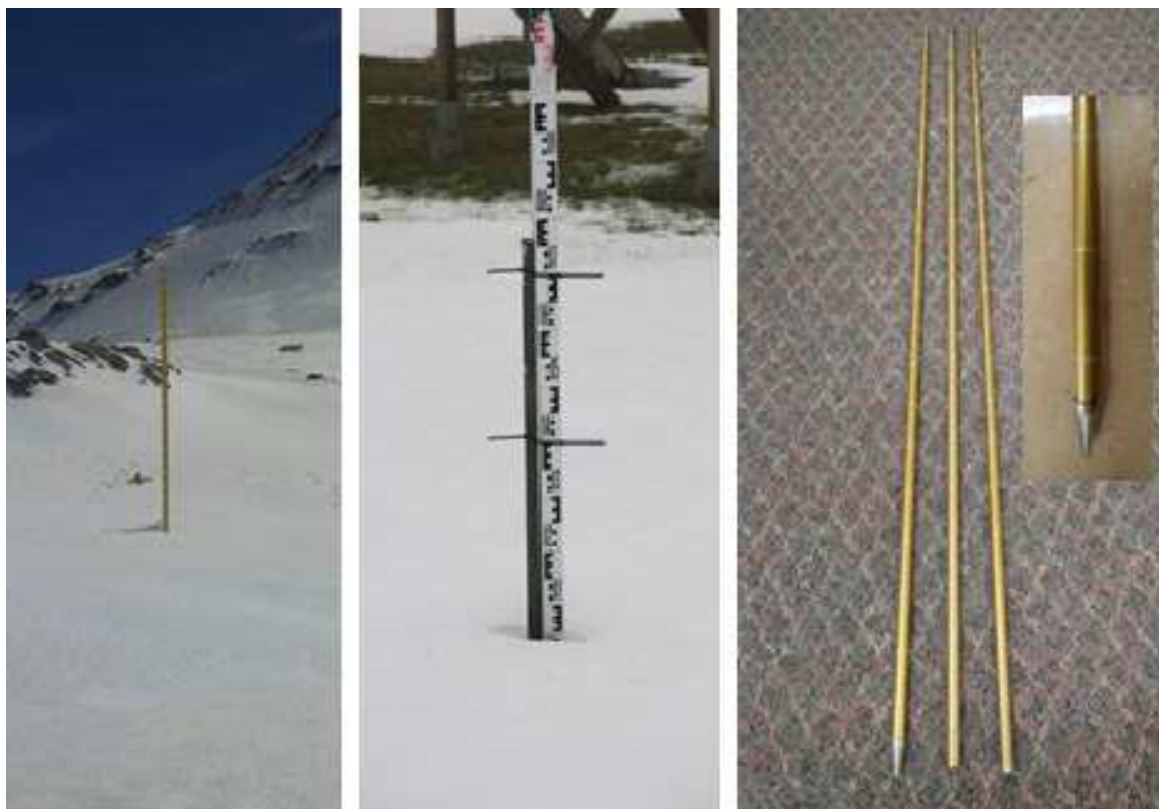
Рисунок 2.2. Градуированные снегомерные рейки в глубоком снежном покрове в горах (слева, Пиренеи, Испания; фото предоставлено Государственным метеорологическим агентством Испании) и в неглубоком снежном покрове (в центре, южная часть провинции Онтарио, Канада; фото предоставлено Министерством охраны окружающей среды Канады (МООСК)). Телескопическая снегомерная штанга с градуировкой 1 см (справа, фото предоставлено МООСК)
