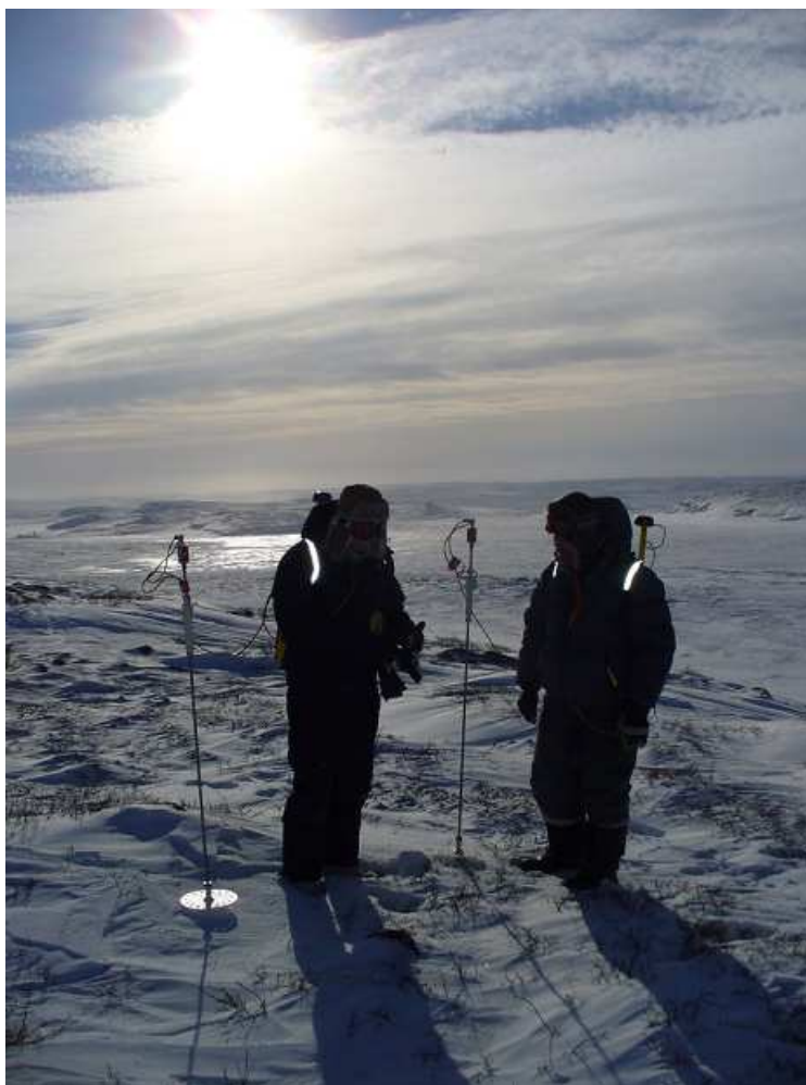
Рисунок 2.5. Регистрирующий снегомерный зонд, оснащенный антенной ГНСС (арктический регион Канады, фото предоставлено Министерством охраны окружающей среды Канады)
