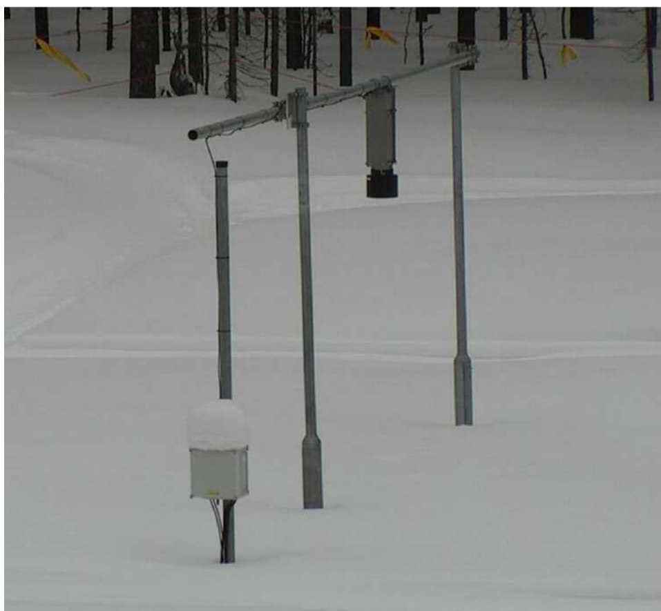
Рисунок 2.18. Прибор для измерения ВЭС на основе пассивного гамма-излучения (фото предоставлено Финским метеорологическим институтом)
