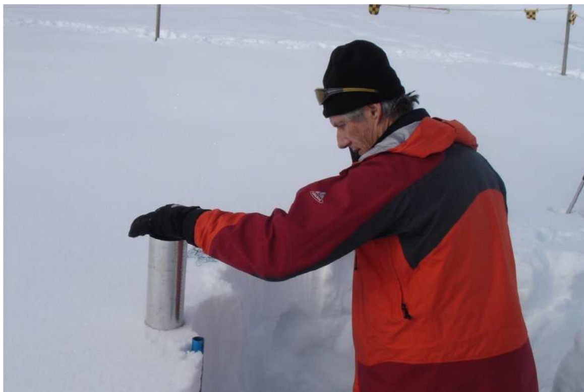
Рисунок 2.13. Отбор проб из верхнего слоя в снежном шурфе с помощью цилиндрического снегомера ЕТН (фото предоставлено Швейцарским институтом исследования снега и лавин, ВСЛ, Давос, Швейцария)
