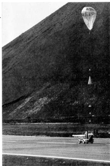
*Рис. 3 — Подъем уравновешенного шара-зонда с аппаратурой на острове Вознесения. Чтобы облегчить запуск шара-зонда, используется тележка, передвигающаяся со скоростью приземного ветра.*
