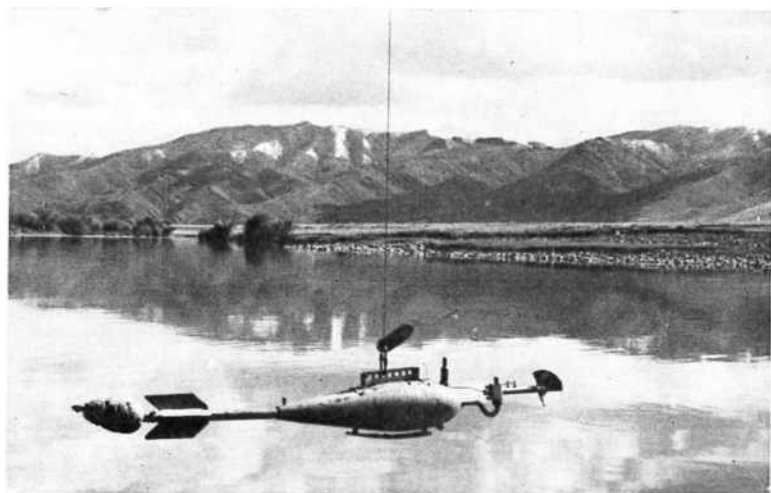
Рис. 3 — Установка для измерения речного стока, используемая Гидрометеорологической службой Монголии
