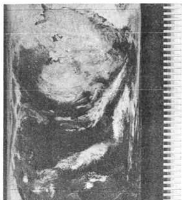
Передачи видимого изображения с NOAA 2 записываются на бумаге Алфакс типа A/GC. Единичное растянутое видимое изображение регистрируется с ленты со скоростью 96 скан/мин.
