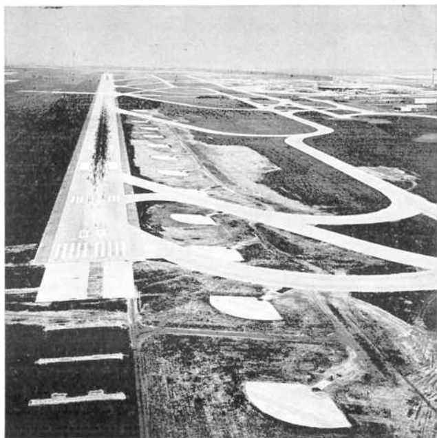
Рис. 1 — В аэропортах Орли и им. Шарля де Голля вблизи Парижа используется метод рассеяния тумана, называемый TURBOCLAIR. Он основан на термокинетическом процессе, при котором над взлетно-посадочной полосой распространяются горячие газы, которые повышают температуру окружающего воздуха настолько, что взвешенные в нем капли испаряются. Такой подъем температуры обеспечивается турбореакторами, отработавшими свой ресурс на самолетах, расположенных по бокам полосы. С помощью соответствующих экранов поток горячего воздуха может быть рассеян в различных направлениях. На фотографии, сделанной в аэропорту им. Шарля де Голля, можно видеть справа от главной взлетно-посадочной полосы места расположения турбореакторов
