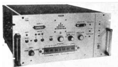
АВТОМАТИЧЕСКАЯ СТАНЦИЯ ПРИЕМА АРТ/WEFAX TIROS N С ЛАЗЕРНЫМ ДИКОДИРУЮЩИМ УСТРОЙСТВОМ
