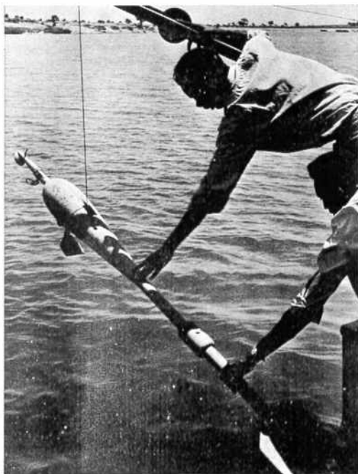
Измерение расхода с помощью гидрометрической вертушки NEYRFLUX на реке Конго.
