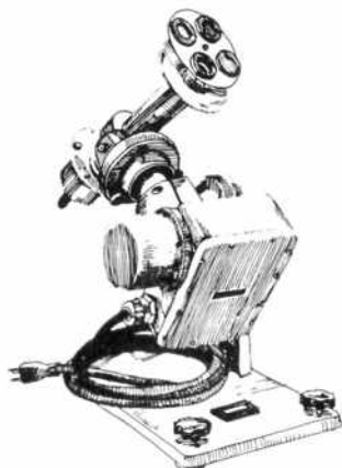
Обычный инсидентный пиргелиометр * (показан с подставкой приема солнечной радиации ЭППЛИ)
