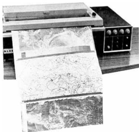
1. Основной регистратор при использовании на существующих сетях каналов звуковой частоты может принимать весь поток синоптических карт со скоростью 120 об/мин, 96 или 48 линий на дюйм. Цифровые и ИК фотомозаики с 16 тональными оттенками могут дополнить сейчас Ваши передачи наряду с действующими или нанесенными на ленту передачами АРТ со скоростью 240 об/мин.
