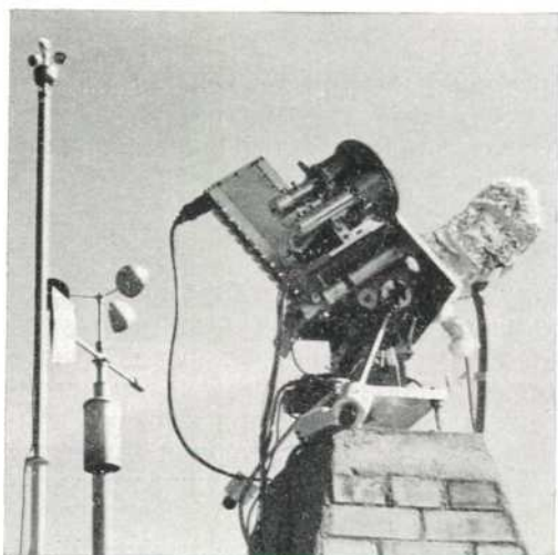
Гелиостат с давосским стандартным пиргелиометром, актинометром и управляющим устройством слежения за Солнцем
