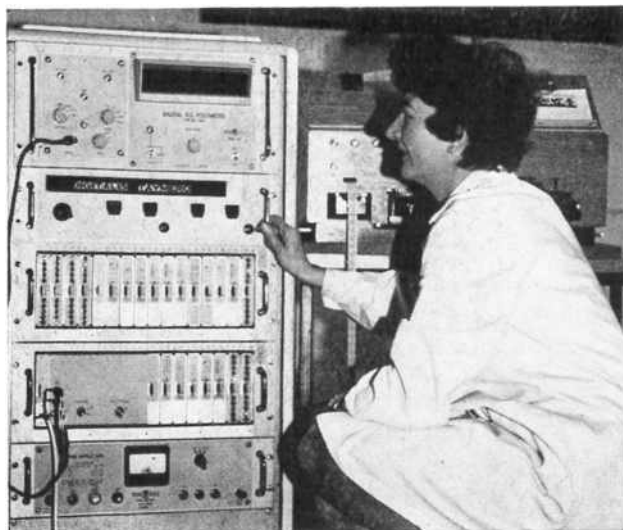
Проверка главного узла цифрового телеметрического оборудования.
