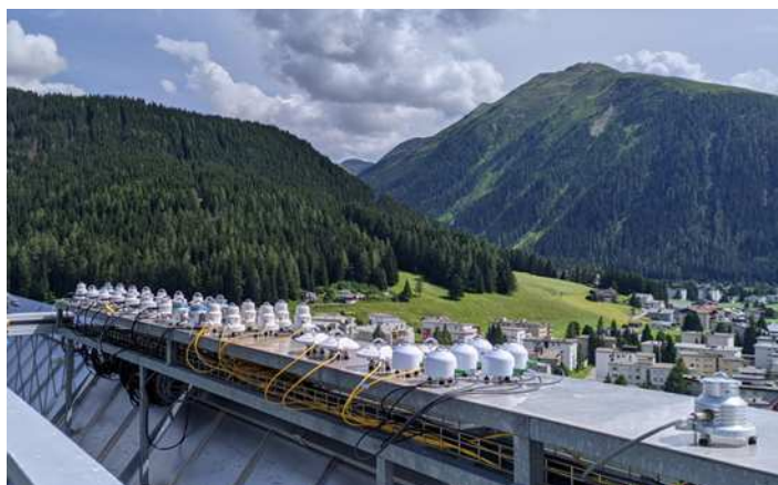
Рисунок 7. Солнечные УФ-радиометры с фильтром на измерительной платформе ДФМО/МРЦ
