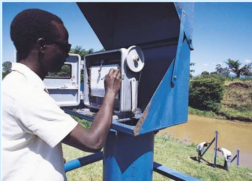
Доброволец (справа) обучается использованию свайного водомерного поста; его показания можно сравнивать с показаниями от автоматического самописца уровня воды на переднем плане (П. Мосли)
