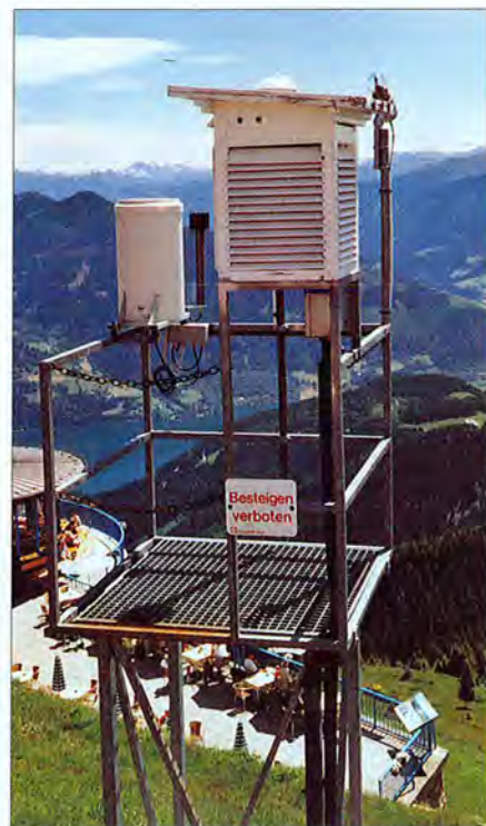
Постоянные наблюдения за метеорологическими переменными в суровых условиях, таких, как в горных районах, может осуществляться только с помощью автоматических метеорологических станций (Фото: К. Шульц)
