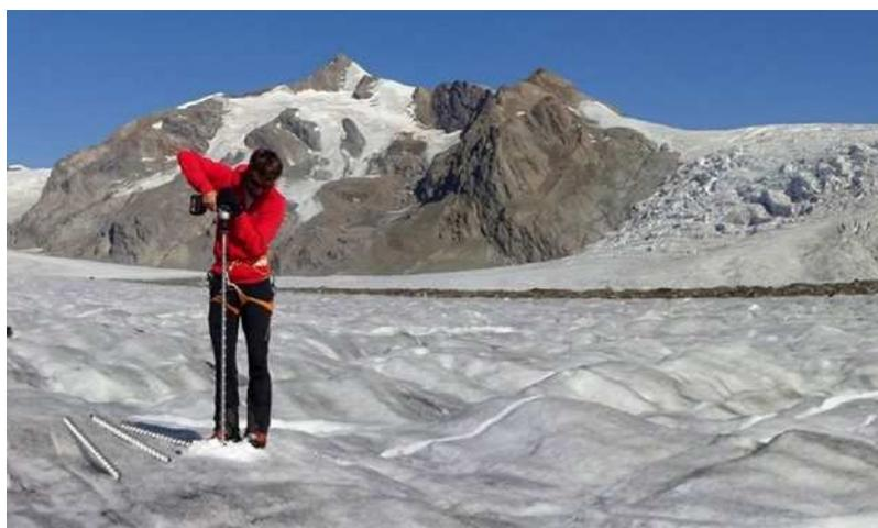
**Рисунок 3.22.** Бурение отверстия с помощью ручного электробура
