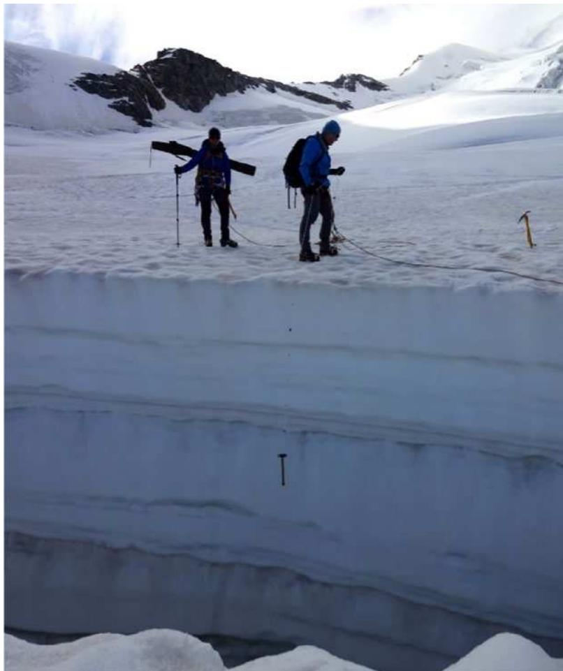
**Рисунок 3.15. Определение аккумуляции по стратиграфии трещин**
