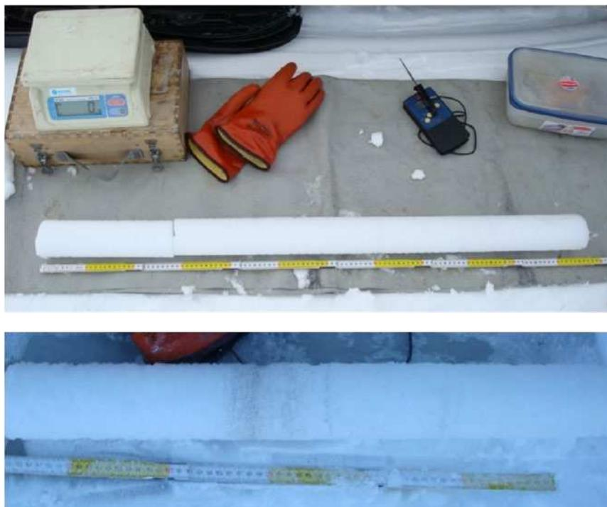
**Рисунок 3.13.** Керн длиной 117 см, пробуренный через мелкозернистый зимний снег в верхней части зимнего слоя (вверху). В этом керне не наблюдается особых стратиграфических признаков. Летняя поверхность предыдущего года, содержащая видимую пыль и демонстрирующая переход от мелко- или среднезернистого зимнего снега к крупнозернистому фирну предыдущей зимы (внизу). Место: ледяная шапка Хофсйокудль, Исландия (высота 1790 м).
