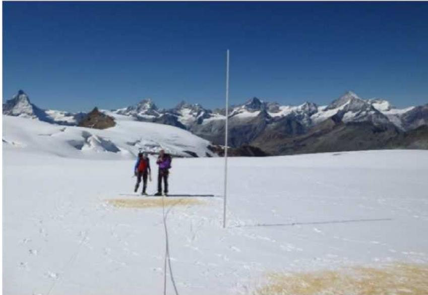
**Рисунок 3.14. Площадка измерений в зоне аккумуляции швейцарского ледника. Поверхность в конце лета помечена опилками.**
