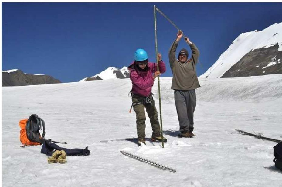
**Рисунок 3.19. Установка легких бамбуковых реек в скважину на высоте ~5 500 м на леднике Рикха Самба в Непале. Перед установкой в скважину короткие (1—2 м) секции необходимо соединить с помощью резиновой муфты, металлического рукава или проволочного соединения (Kaser et al., 2003).**
