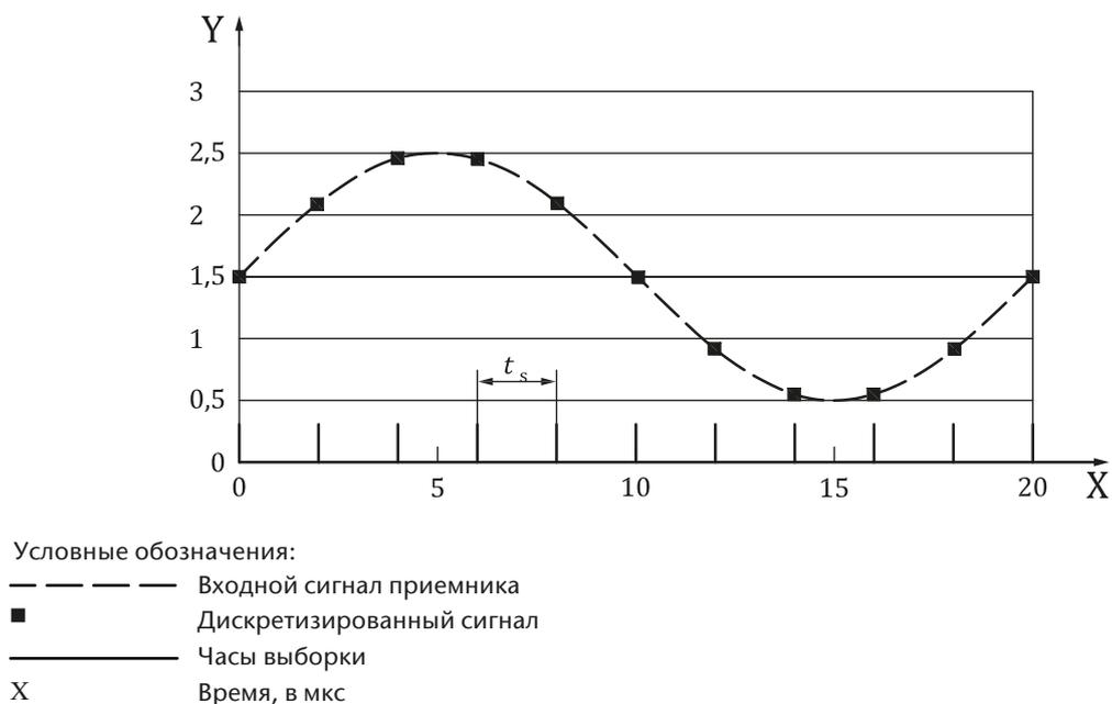
Рисунок А.17. Пример экрана осциллографа
