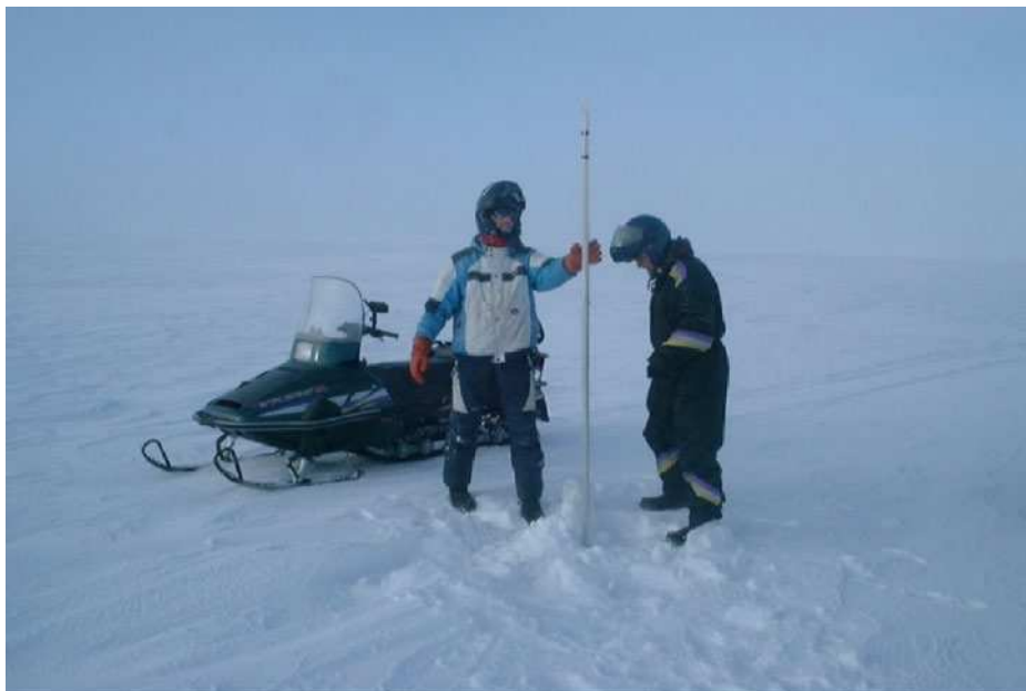
Рисунок 3.18. Установка 6-метровой алюминиевой рейки в скважину, пробуренную снеговым керноотборником
