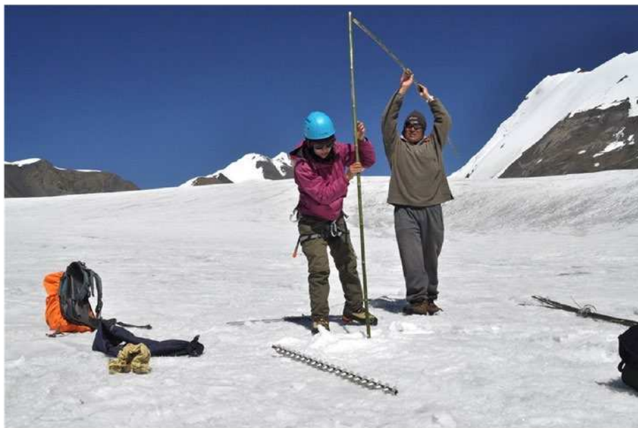
Рисунок 3.19. Установка легких бамбуковых реек в скважину на высоте ~5 500 м на леднике Рикха Самба в Непале. Перед установкой в скважину короткие (1—2 м) секции необходимо соединить с помощью резиновой муфты, металлического рукава или проволоочного соединения (Kaser et al., 2003).
