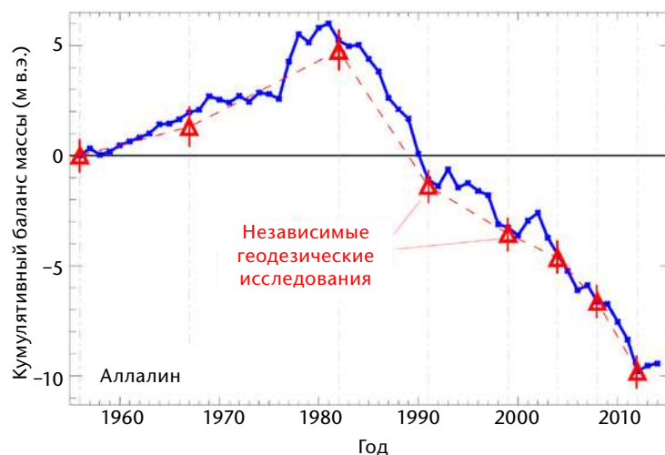
Рисунок 3.33. Ледник Аллалин, Швейцария: сравнение годовых рядов баланса массы, полученных на основе гляциологического метода (синий цвет), с независимыми изменениями объема льда (красный цвет), полученными на основе периодических геодезических съемок
