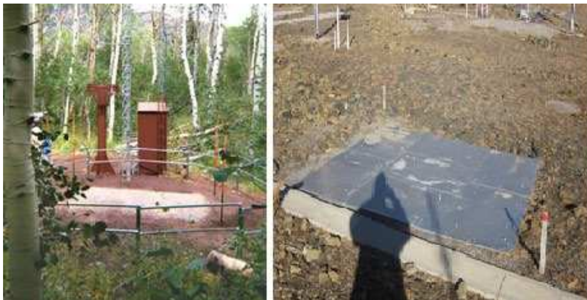
Рисунок 2.17. Рабочая площадка со снеговой подушкой (слева, фото предоставлено Министерством сельского хозяйства США) и снеговые весы (справа), где центральная панель является чувствительным элементом (фото предоставлено Швейцарским институтом исследования снега и лавин, ВСЛ, Давос, Швейцария)
