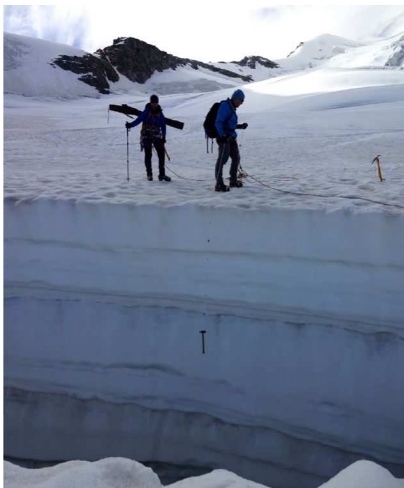
Рисунок 3.15. Определение аккумуляции по стратиграфии трещин
