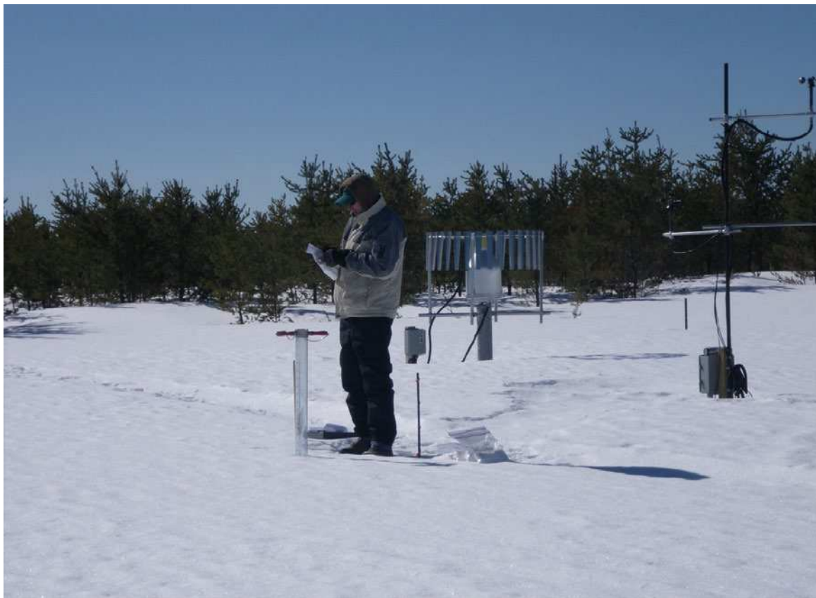
Рисунок 2.14. Отбор проб с помощью снегоотборника (фото предоставлено Министерством охраны окружающей среды Канады)
