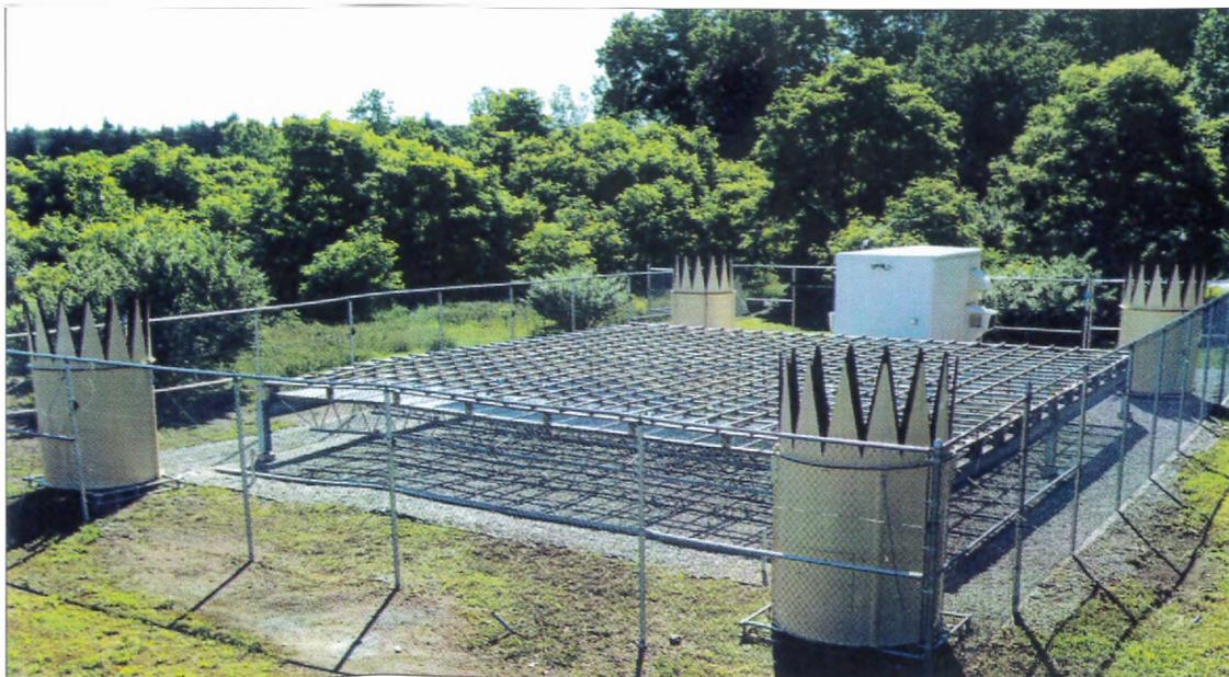
*Профилометр ветра с радиоакустической системой зондирования (НУОА, США)*
