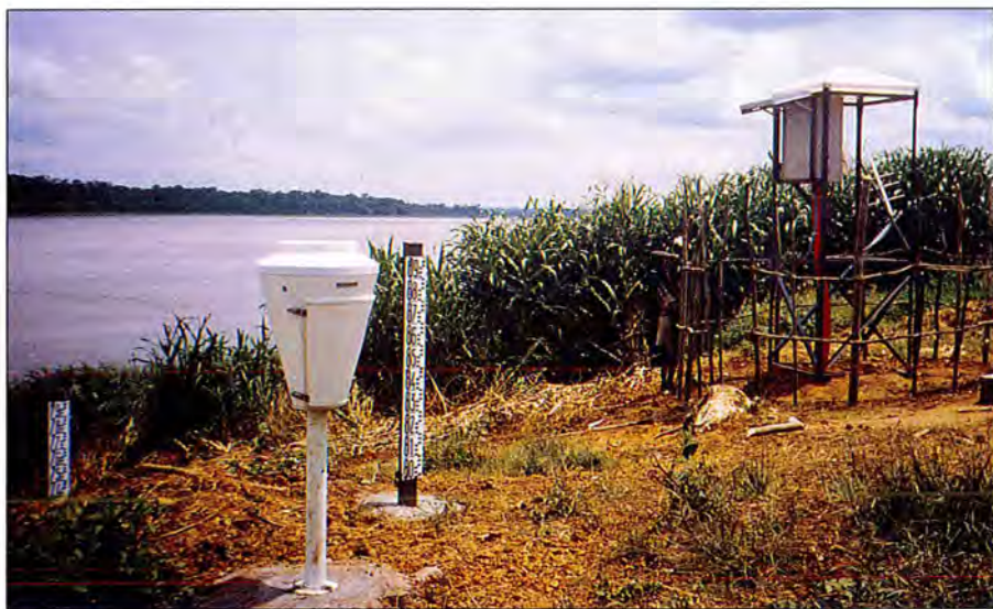
Платформы сбора данных, используемые для передачи данных ВСНГЦ-Африка через спутник в региональные и глобальные центры для обработки и использования (ОРСТОМ/Юты)
