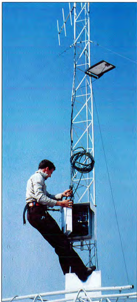
На вновь возведенной метеорологической вышке техник проверяет устройство записи данных, заключенное в белый кожух, с тем, чтобы убедиться в правильной работе приборов и в наличии надлежащей связи с основной станцией. (Рэнди Уайт)
