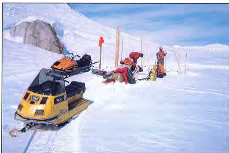
Измерения при помощи радиолокатора толщины ледника, ледник Стегхолт Норвегия (Фото: Б. Волд).
