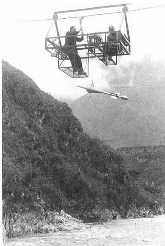
Измерения расхода воды на реке Пастаза в верховьях реки Амазонки.
