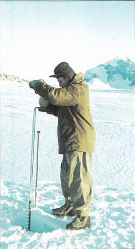
Бурение для измерения толщины многолетнего льда в заливе в Антарктике
