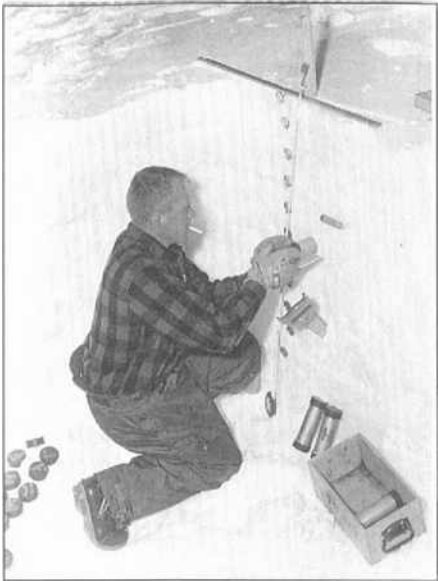
Измерения температуры снега в Антарктике и плотности в скважине ледяного шельфа на станции Литл Америка III
