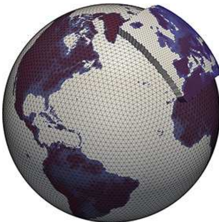
Рисунок 2.22. Схематическое изображение икосаэдрической сетки с региональным уточнением для Европы, применяемой Метеорологической службой Германии ( Deutscher Wetterdienst )
