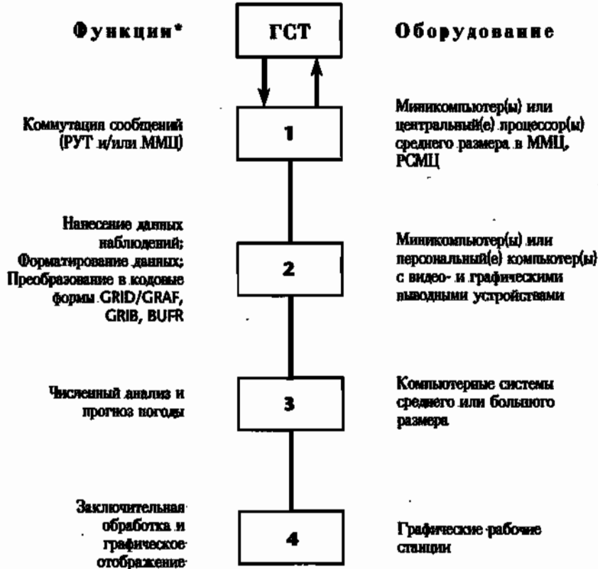
Рисунок 3.2 — Функции и оборудование автоматизированных ММЦ, РСМЦ или НМЦ. (*Все функции могут быть осуществлены одной большой ЭВМ, а также существует несколько сочетаний функций и ЭВМ)
