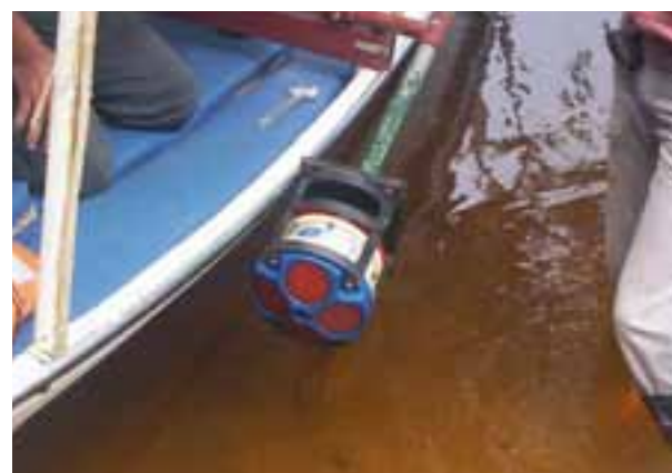
Рисунок 1.5.4. Измерительный преобразователь акустического доплеровского прибора, установленного на лодке
