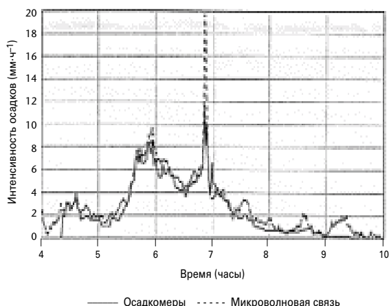
Рисунок I.3.11. Временные ряды оценок количества осадков, полученных с помощью осадкомеров (сплошная линия), и измерения затухания двухчастотной микроволновой связи (пунктирная линия) над северо-западом Англии, 10 февраля 2000 г. (Holt and others, 2000)
