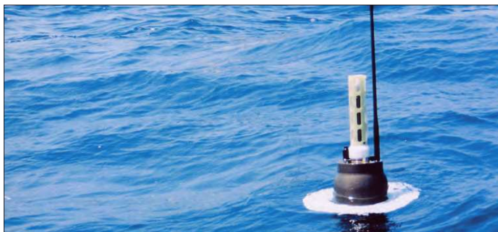
Рисунок 2.5. Ныряющий буй, который опускается на глубину порядка 2 000 метров
