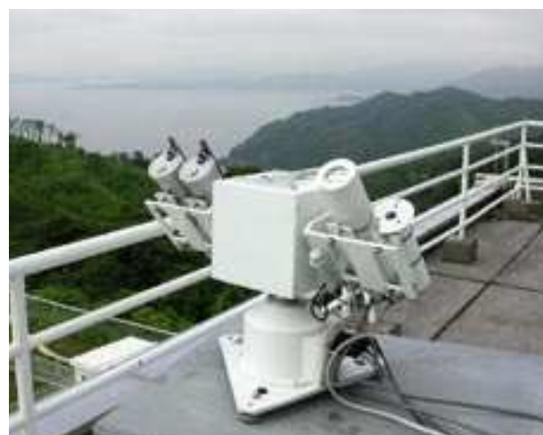
Аэрозольный фотометр для слежения за Солнцем, станция ГСА Риори, Япония.
