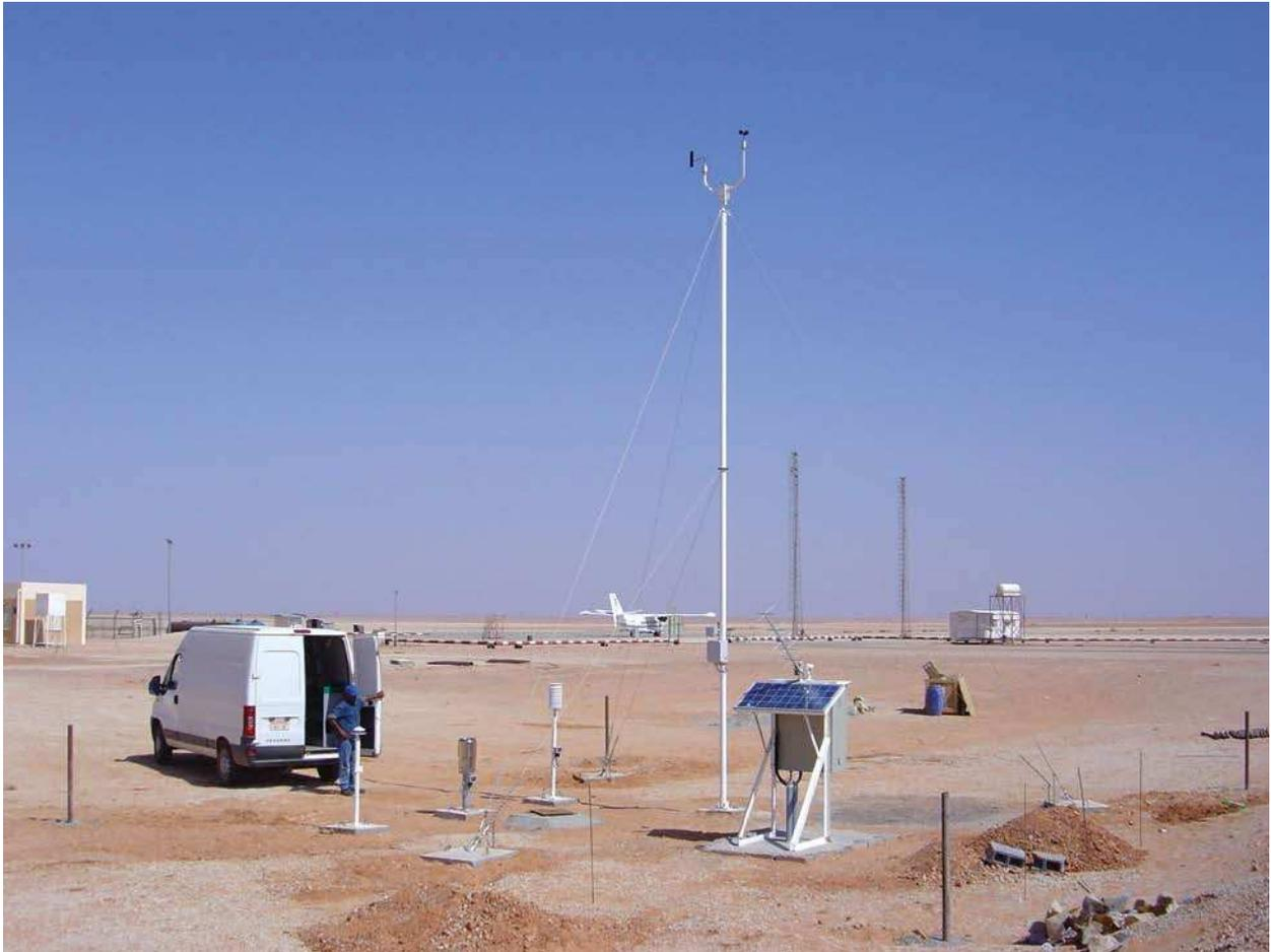
*Для метеорологических и климатических наблюдений все больше применяются автоматические метеорологические станции, поскольку их можно использовать без обслуживания человеком в течение длительного времени. Они оснащены современными датчиками и алгоритмами обработки и особенно ценны в удаленных районах или в районах неблагоприятными условиями окружающей среды, таких как пустыни и горные районы.*
